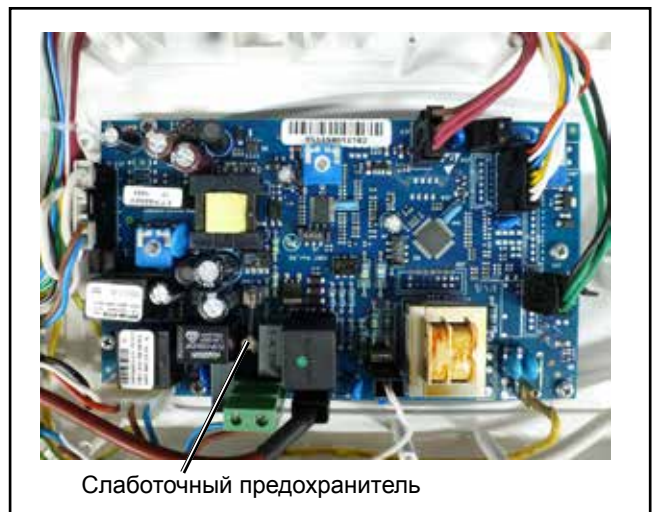
Рис. Замена предохранителей
