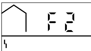
Неисправности отображаются на дисплее мигающим кодом (например, "F2") с символом неисправности .
