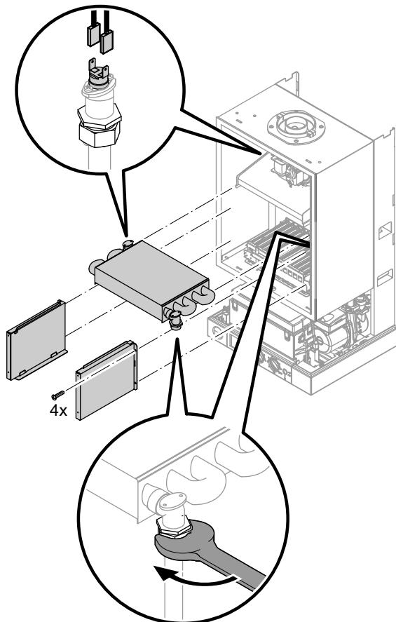
При откручивании резьбовых соединений отопительного контура необходимо придерживать вторым гаечным ключом.
