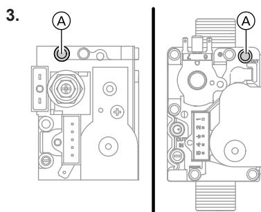
Ослабить, полностью не вывинчивая, винт в измерительном штуцере (A) и подсоединить манометр.
