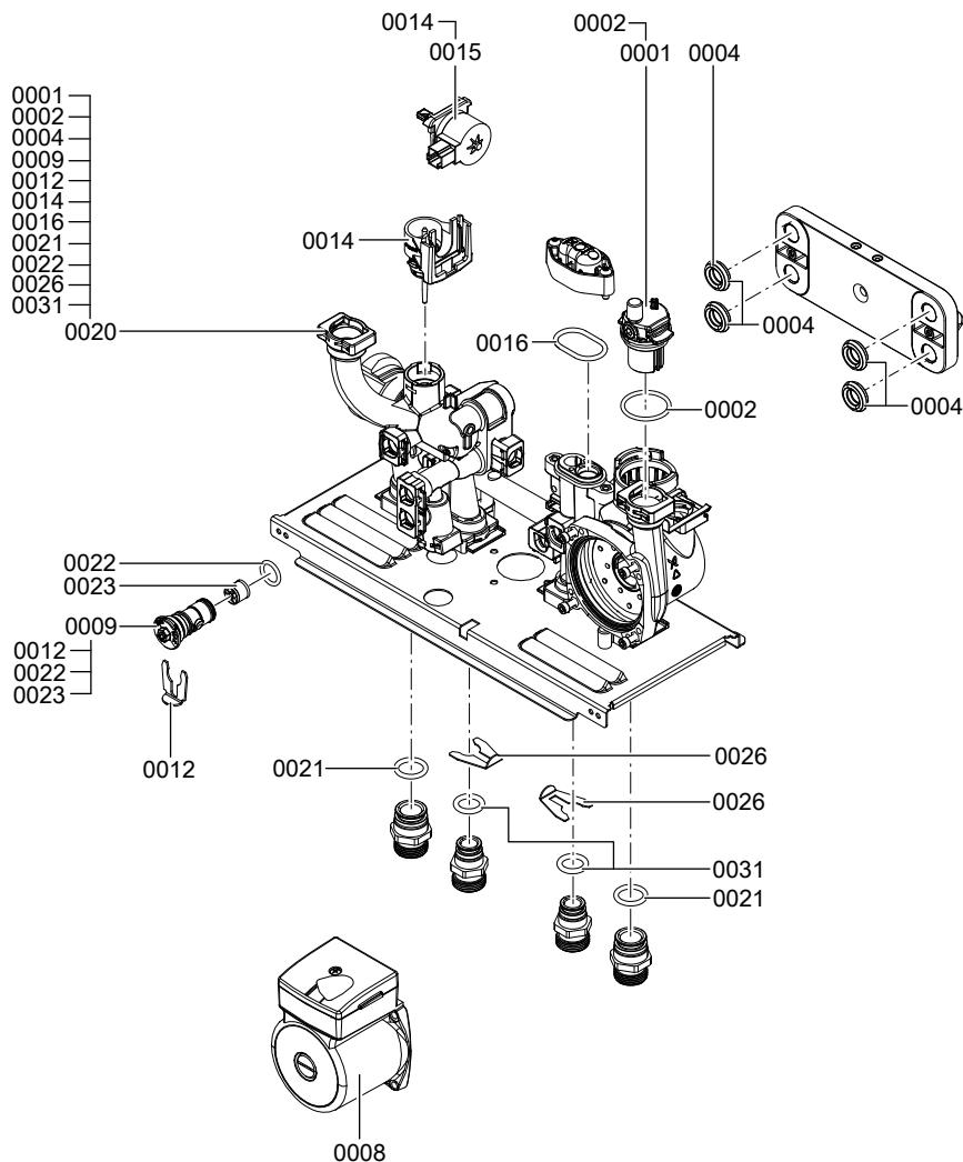
**Узел комбинированного контура гидравлики**
