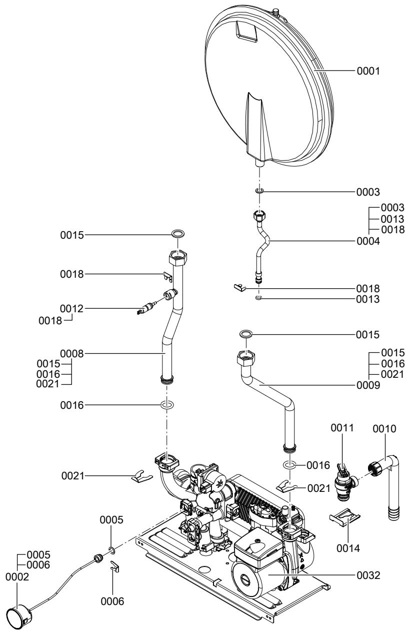
**Узел циркуляционного контура гидравлики**
