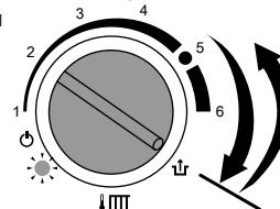
Для разблокирования повернуть "ручку настройки" "III" на короткое время до упора вправо и затем вернуть в прежнее положение. Процесс розжига повторяется.
