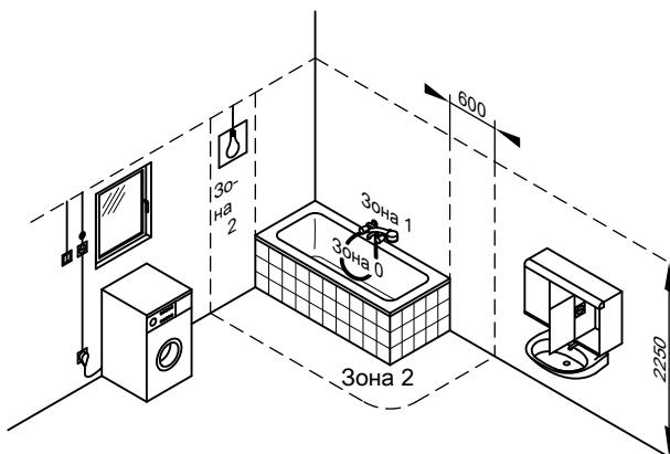
Котел Vitopend допущен для монтажа в сырых помещениях (например, в ванной или душевой комнате) (степень защиты IP X4 D, брызгозащищенный).
