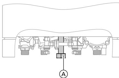
1. Смонтировать запорный газовый кран на патрубке газа **(A)**. Момент затяжки  $30 \pm 2$  Нм.
