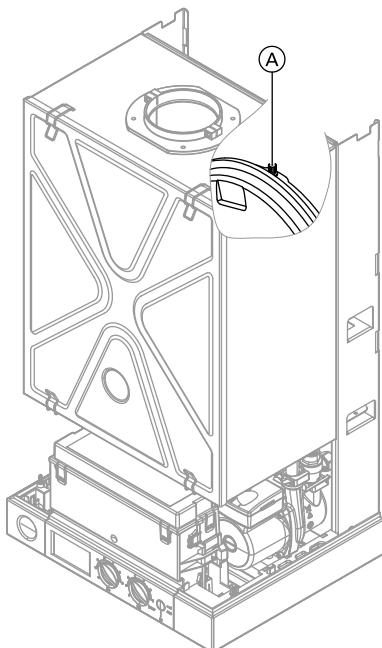
Проверить давление на входе мембранныго расширительного бака на измерительном ниппеле **(A)**, при необходимости пополнить.
