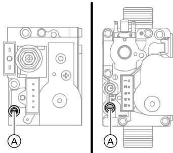
Не вывинчивая, ослабить винт в измерительном штуцере **(A)** газовой регулирующей арматуры и подсоединить манометр.
