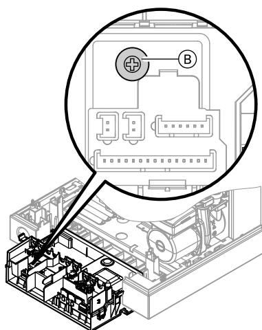
Повернуть потенциометр (B) отверткой влево настолько, чтобы давление газа на жиклере по манометру соответствовало требуемой мощности согласно таблице на стр. 36.
