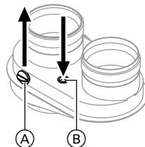
1. Подключить газоанализатор к измерительному отверстию (A).
