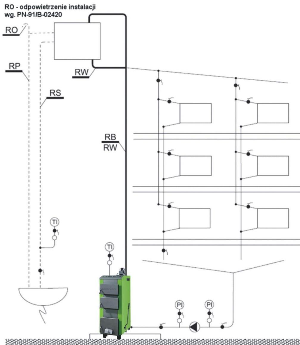
*Рис. 5. Пример схемы защиты водяного отопления оснащенного одним котлом, насос установлен на возврате*
