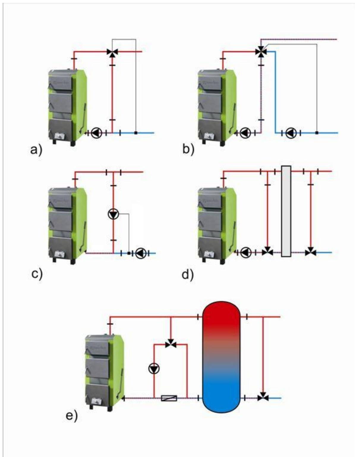
**Рис 4. Рекомендуемые схемы соединения котла SAKOVICH с системой отопления: а) с трехходовым клапаном; б) с четырехходовым клапаном; в) с циркуляционным насосом; г) с гидравлической муфтой; д) с буферной ёмкостью**
