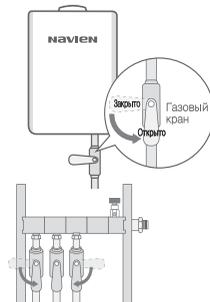
**4. Заполнение котла и системы отопления водой.**
