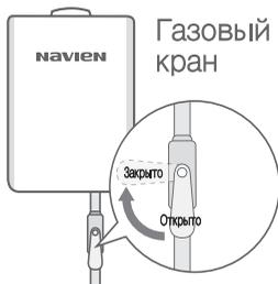
**3. Проверьте положение запорных и распределительных кранов в системе отопления.**
