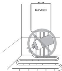
3. Котлы Navien Deluxe оснащены встроенными сетчатыми фильтрами отопительной воды. На обратном трубопроводе системы отопления, перед котлом, рекомендуется установить дополнительный косой сетчатый фильтр, для очистки отопительной воды от нежелательных примесей.
