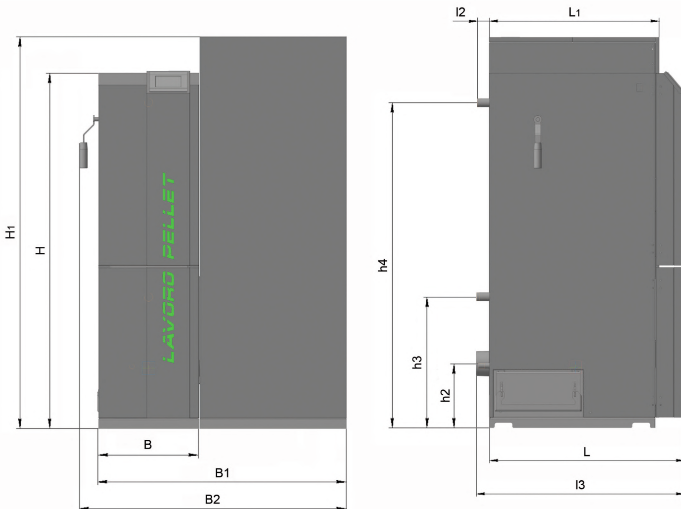
Рисунок 1. Габаритные и присоединительные размеры Котла LP-37
