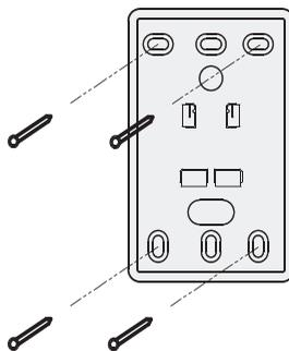
С котлом выносной пульт управления соединяется двумя проводами. Не прикладывайте чрезмерных усилий при соединении проводов и при затягивании шурупов.
