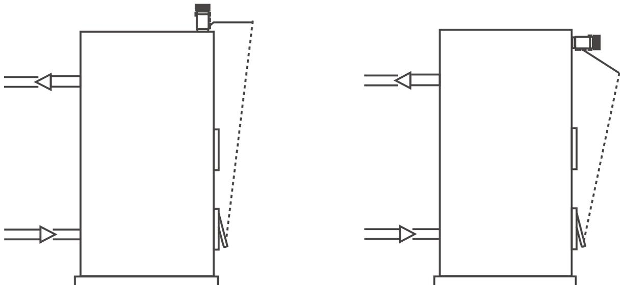
Регулятор тяги подключается к котлу в вертикальном или горизонтальном положении, резьбовое соединение  $\frac{3}{4}$ " герметизируется уплотнительными материалами. Цепь подключить к рычагу регулятора тяги и к воздушной заслонке твердотопливного котла.
