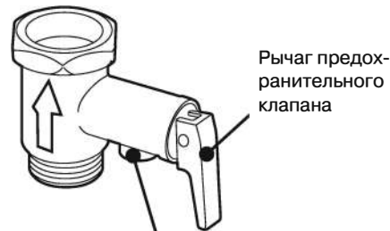
Выпускное отверстие предохранительного клапана
