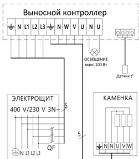
Схема подключения каменок серии FT-BW
