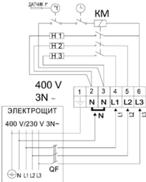
Схема подключения каменок
