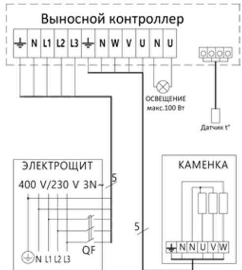
Схема подключения каменок
