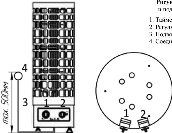
**Рисунок 1.** Внешний вид и подключение каменки.
