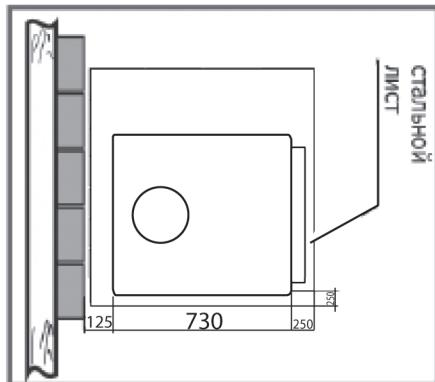
горючих материалов, примыкающие под углом к фронту печи, защищается штукатуркой толщиной 25 мм по металлической сетке, кирпичной кладкой или металлическим листом по асбестовому картону толщиной 8 мм, высотой от пола до уровня 250 мм выше верха печи. Должен быть обеспечен приток свежего воздуха в объёме, необходимом для работы печи.
