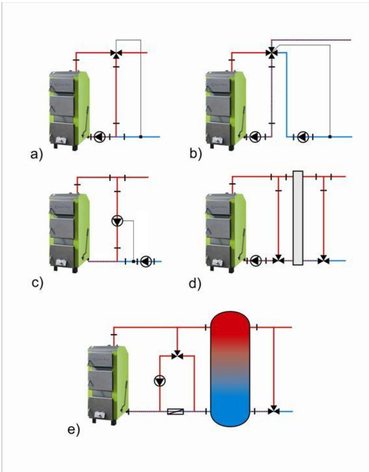
**Рис 4. Рекомендуемые схемы соединения котла SAKOVICH с системой отопления: а) с трехходовым клапаном; б) с четырехходовым клапаном; в) с циркуляционным насосом; д) с гидравлической муфтой; е) с буферной ёмкостью**
