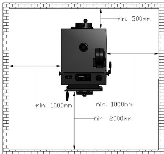
**Рис 3. Установка котла в котельной**
