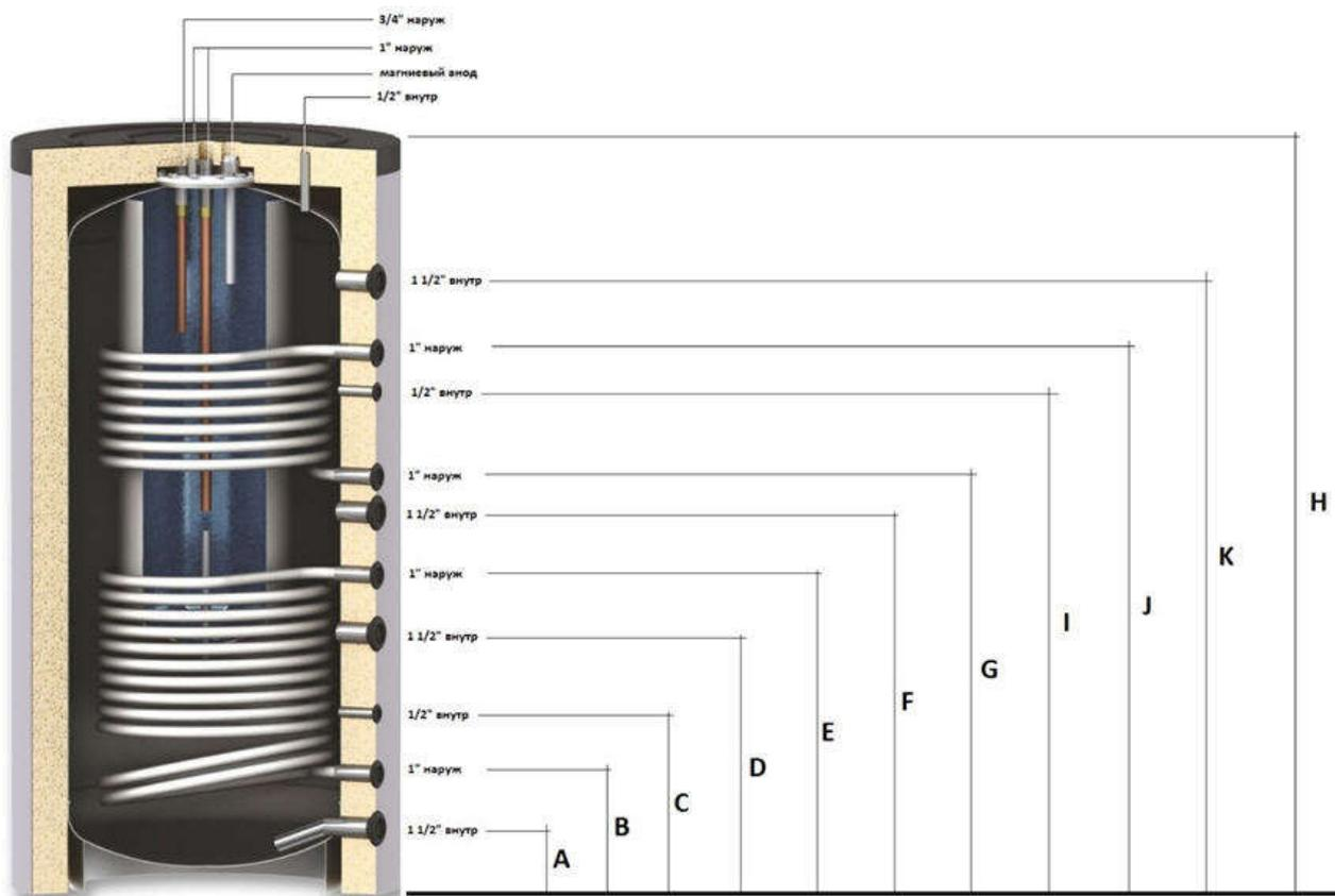
Область применения: - Накопление и аккумулирование нагретой санитарной воды, а так же аккумулирование тепла системы отопления
