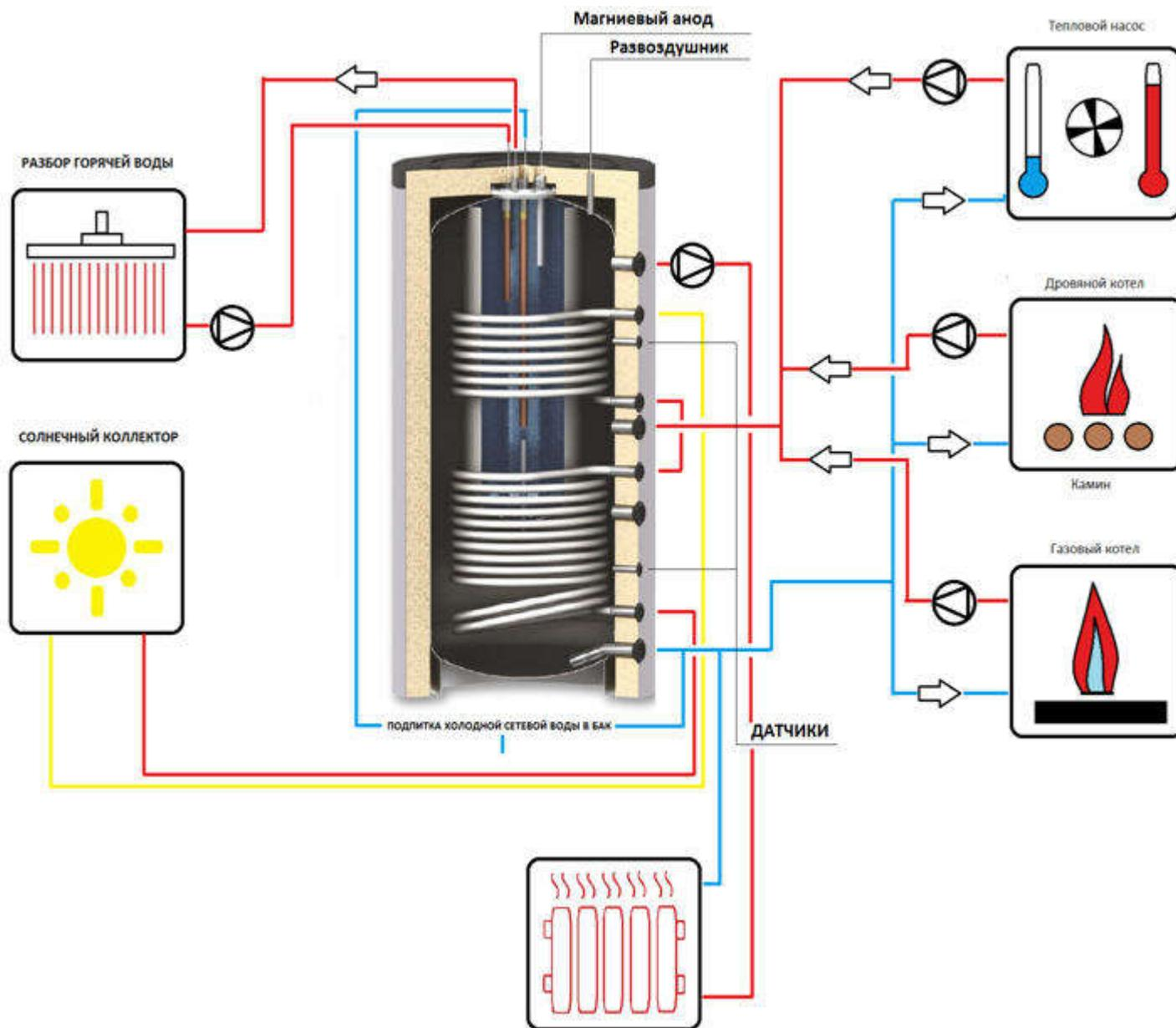
**Баки серии ТТ предназначен для использования в системах ОТОПЛЕНИЯ И ГОРЯЧЕГО ВОДОСНАБЖЕНИЯ!**
