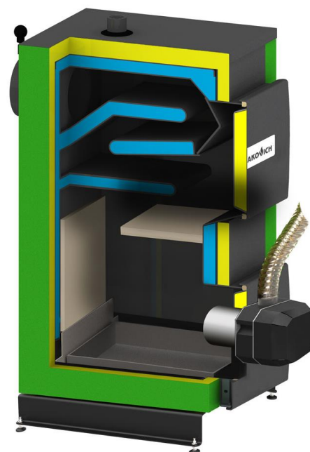
Разрез котла W Pellet
