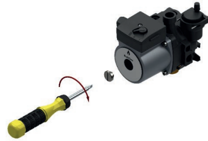
Рис. 5 Проверка циркуляционного насоса
