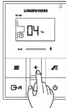
Когда мигает значок ☼ нажмите кнопку + или — и выберите желаемое время повторной работы отопления в пределах 0~12 часов, информация сохраняется автоматически. За единицу времени принимается 1 час. Если установить время остановки на (04), как изображено на рисунке, то котел будет работать в течение 30 мин. каждые 4 часа.
