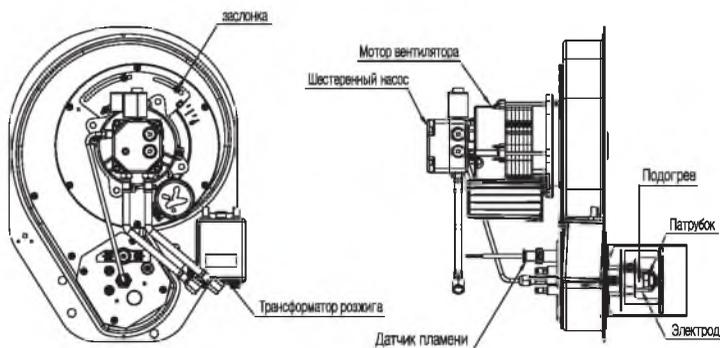
Датчик пламени : следит за пламенем в горелке и поддерживает безопасную работу горелки.
