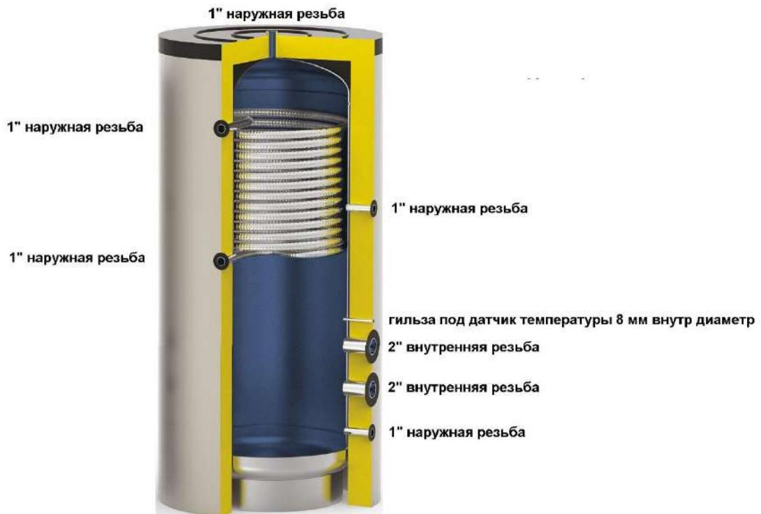
Принципиальная схема монтажа
